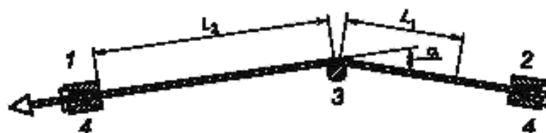
1 — активная сторона; 2 — пассивная сторона; 3 — опорный ролик; 4 — захваты; L_1 = (700 \pm 50) мм; L_2 \geq 700 мм; \alpha = 20^\circ \pm 0,5^\circ
