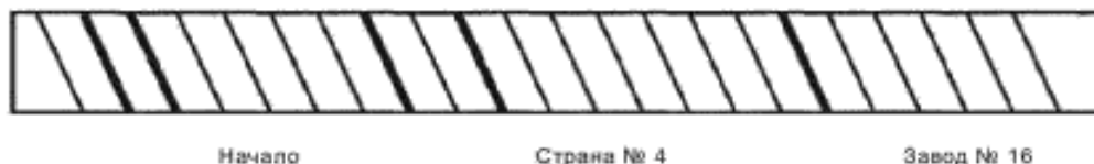
Рисунок 5 — Пример маркировки для идентификации страны происхождения и завода (с применением утолщенных ребер)
